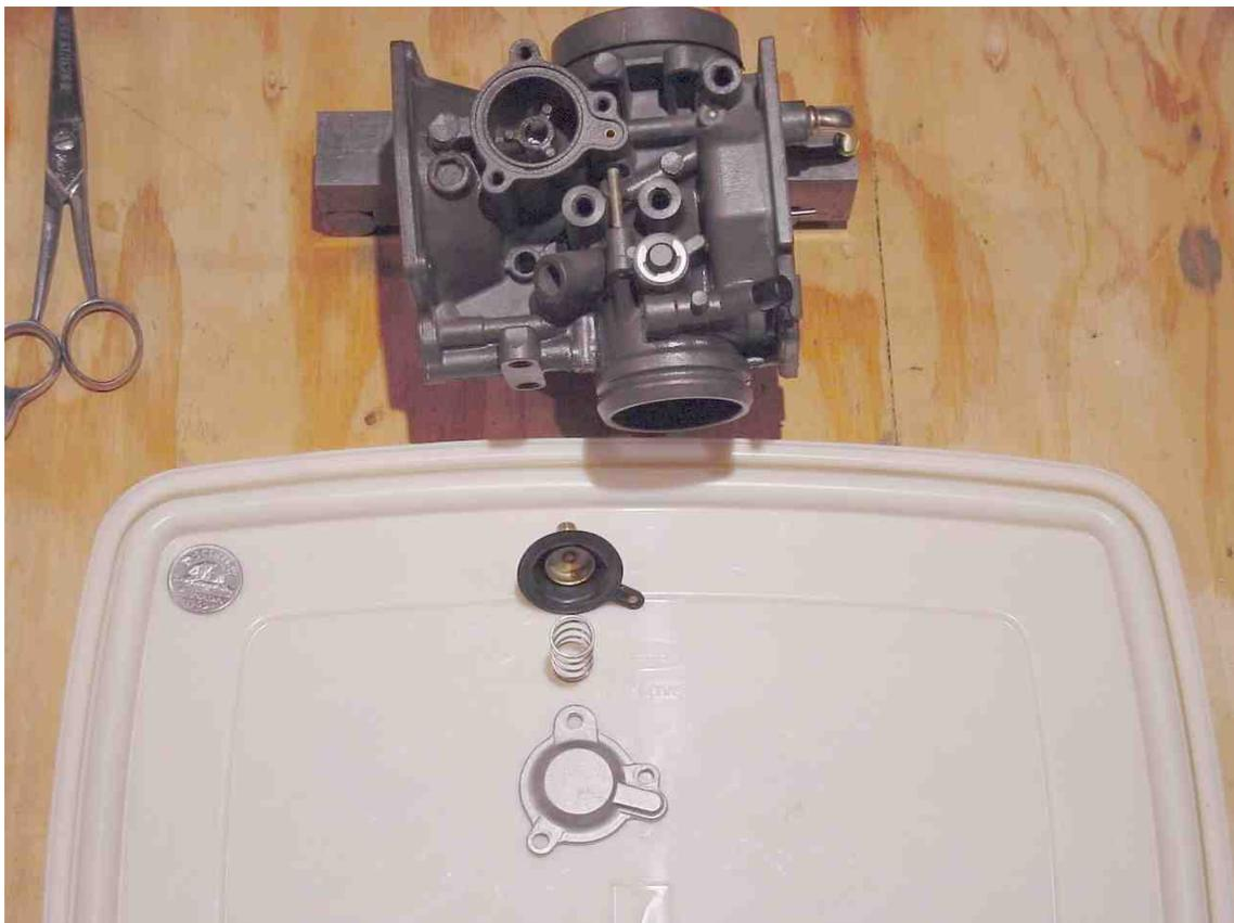
Vue du diaphragme, du ressort et du couvercle du clapet d'enrichissement :
