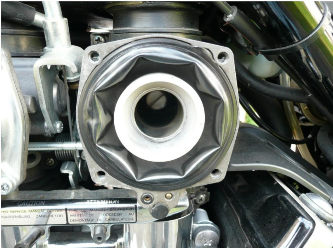
Vue du petit joint torique placé dans son logement sous la membrane.
